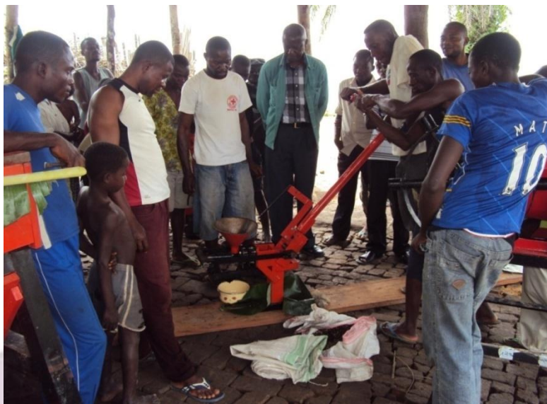
Ci – dessus, ISANGI : Test d'exploitation de la RAM PRESSE SEMENCES HUMIDES ET PRESSAGE DIFICILE
