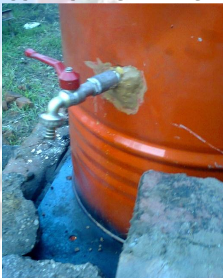
DETAILS SUR LA BRIDE DE SERRAGE DU ROBINET DE SOUTIRAGE PHASES OPERATIONNELLES DU CLARIFICATEUR
