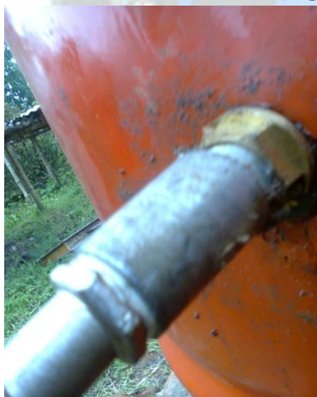
DETAILS SUR LA BRIDE DE SERRAGE DU ROBINET DE SOUTIRAGE PHASES OPERATIONNELLES DU CLARIFICATEUR
