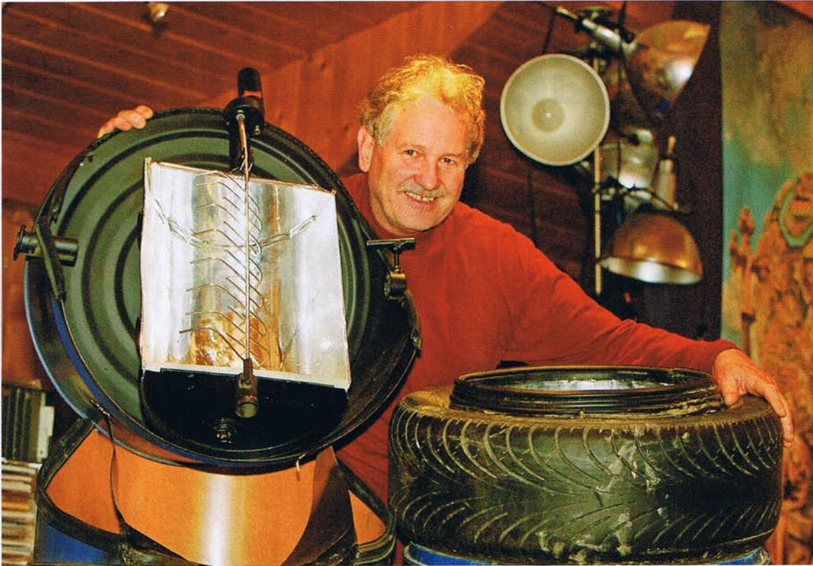
Ronald Blanc et son four solaire muni d'un réflecteur fabriqué avec une tôle recouverte de papier d'aluminium. Pour mieux récupérer la chaleur.
